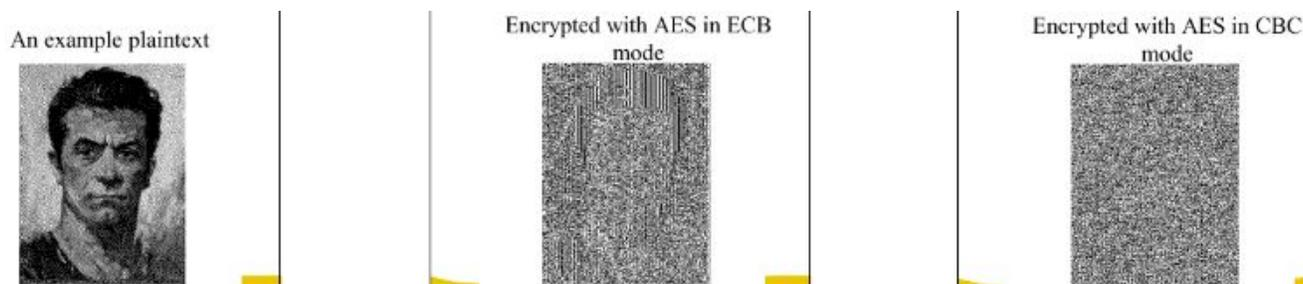
*Image chiffrée avec AES en mode ECB : on distingue les cheveux qui sont tous de la même couleur. On reconnaît des choses. Par défaut on utilise donc plutôt le mode CBC.*
